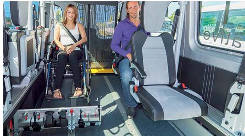
Wird die RolliBox nicht benötigt, können die ergonomischen Klappsitze genutzt werden. Diese sind, wie auch die Kopfstützen, auf Rasterschienen an der Fahrzeugwand befestigt. Hierdurch können Sie je nach Bedarf verschoben werden.
