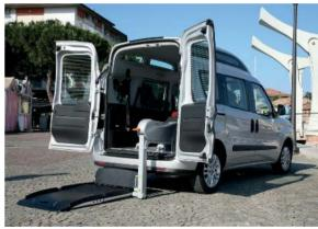
Die halbautomatische Version ist für begleitete Rollstuhlfahrer optimiert. Die vollautomatische Variante ermöglicht den Einstieg ins Fahrzeug auch für Selbstfahrer.
