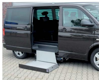
Bei extremen Wetterbedingungen ist die Mechanik des Liftes durch die geschlossene Edelstahlkassette geschützt.
