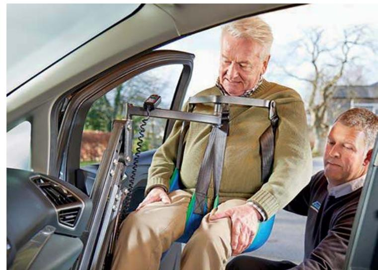
Nach Gebrauch kann der dreiteilige Aluminiumlift abgenommen und sicher in der gepolsterten Tasche verstaut werden. Das schwerste Teil wiegt gerade mal 8 kg.
