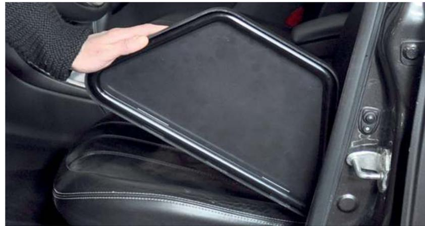
Wenn Ihnen eine fixierte Höhe ausreicht, bietet sich die Umsetzhilfe an. Hier wird die klappbare Sitzfläche, ebenfalls fest an der B-Säule, auf der für Sie passenden Höhe montiert.
