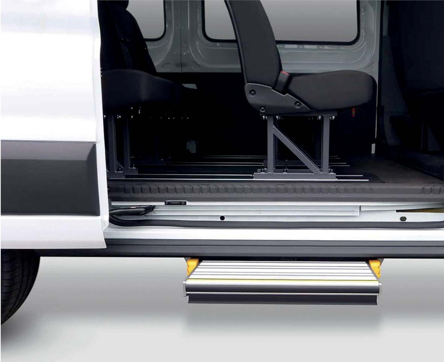
Die Trittstufen gibt es auch in einer vollautomatischen Ausführung, sodass sie beim Öffnen der Türe elektrisch ausfährt. Bei der manuellen Ausführung wird die Trittstufe durch leichtes Einschieben des Auftritts aktiviert.
