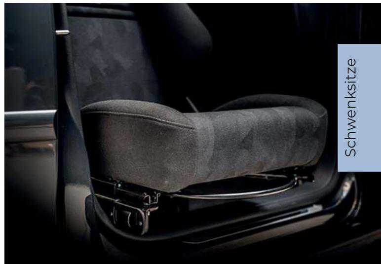
Der originale Beifahrersitz wird durch einen erforderlichen Spezialsitz ersetzt.
