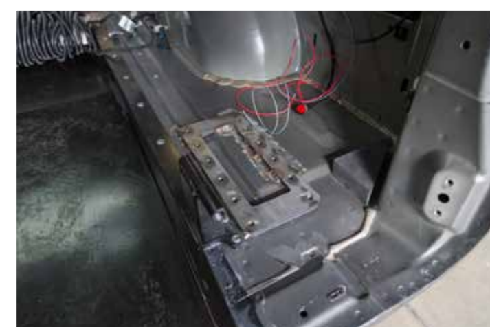
Verankert: für die schwenkbare Rückenlehne werden Verstärkungen angeschweisst.
