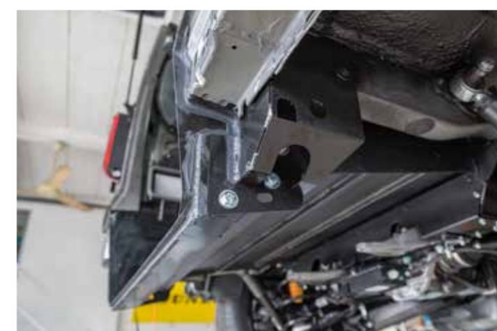
Verankerungen und Aufnahmen werden fest mit dem Auto verschraubt und zusätzlich verklebt.
