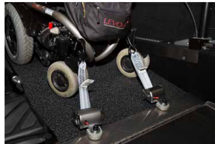
Fest verankert: der Rollstuhl wird mit speziellen Gurten am Fahrzeugboden verzurrt.
