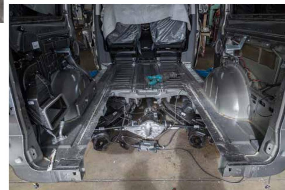
Mit der Säge geht es zur Sache: bei der fabrikneuen V-Klasse wird der Kofferraumboden herausgetrennt.
