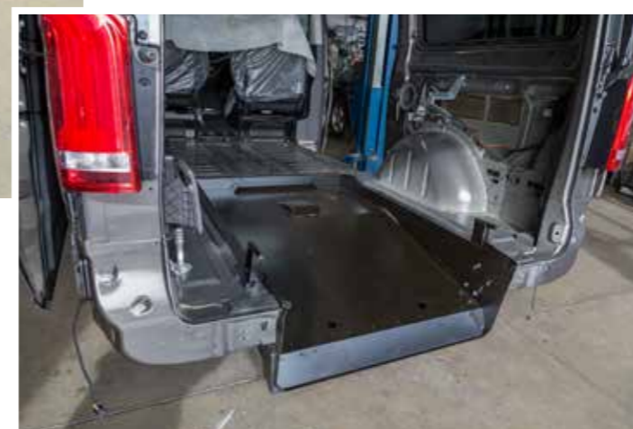
Die Wanne ermöglicht später zusammen mit der Rampe einen flachen Winkel, um mit dem Rollstuhl bequemer auffahren zu können.
